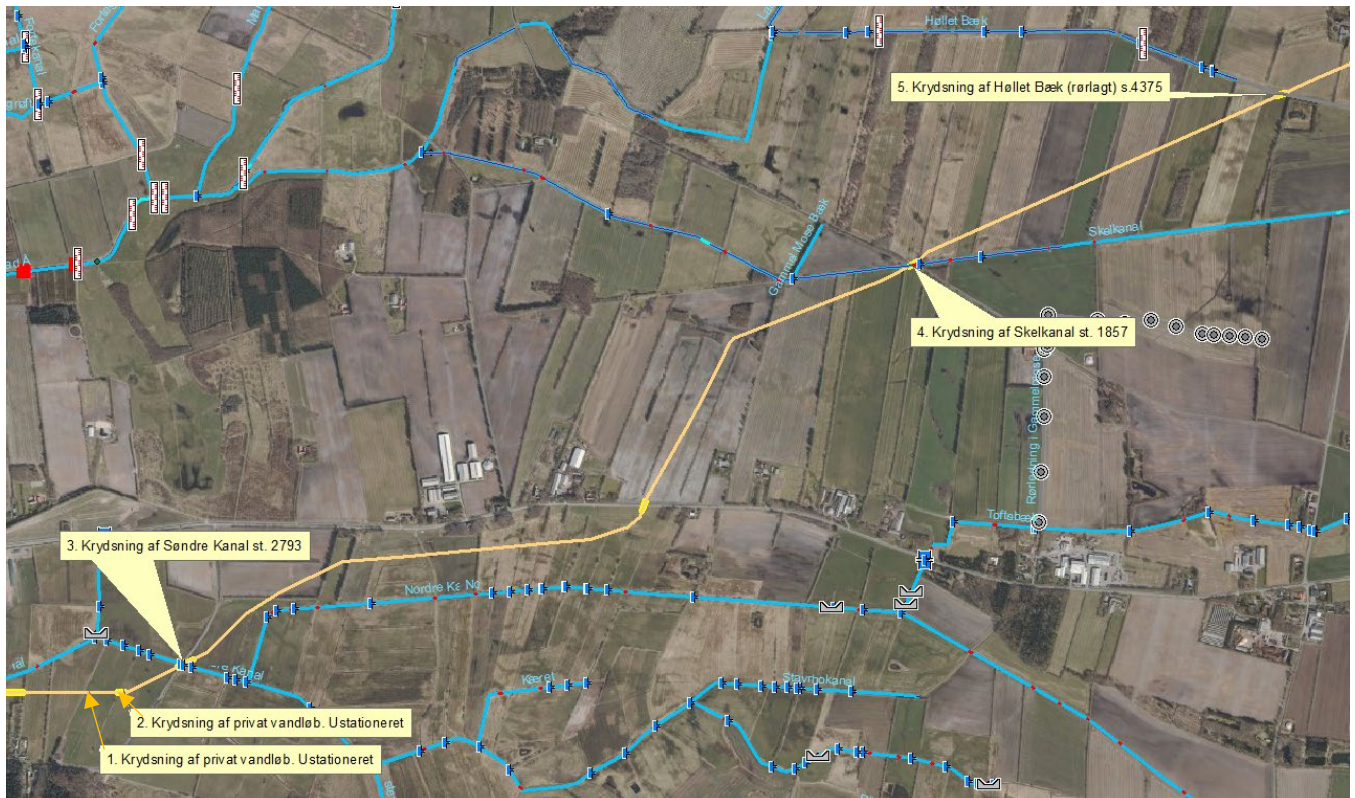
Figur 1. Vandløb der krydses med kabel. Krydsningerne er yderligere forklaret i Tabel 1.
